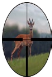
Entfernung ca. 100m: Bild und Absehen liegen in einer Ebene (Parallaxenfrei).
