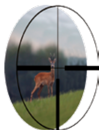
Entfernung ca. 300m: Bildebene liegt hinter dem Absehen (Parallaxenfehler bei schrägem Einblick).
