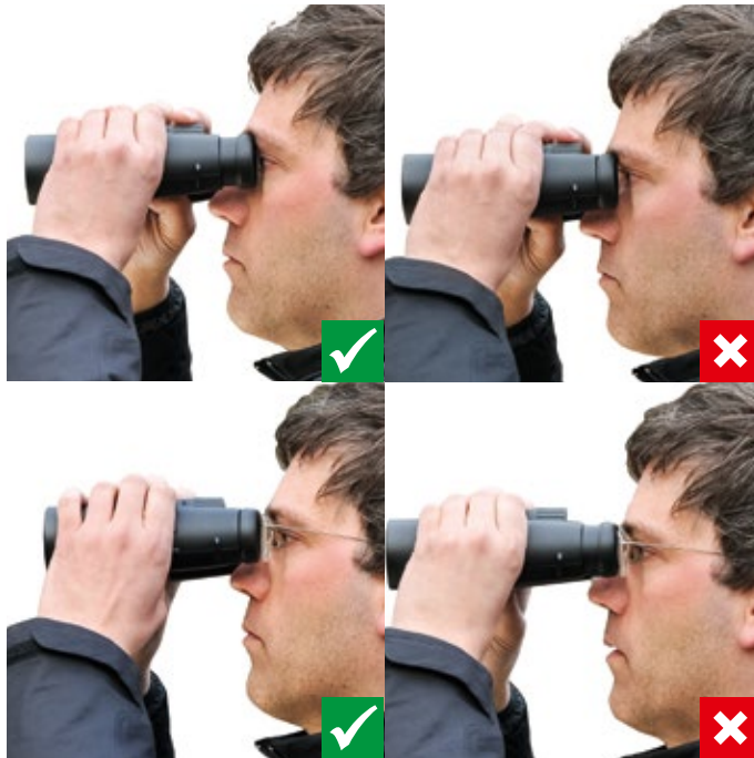
Bei der Beobachtung ohne Brille sollten die Augenmuscheln des Fernglases herausgedreht werden, bei der Beobachtung mit Brille sollten sie reingedreht werden.
