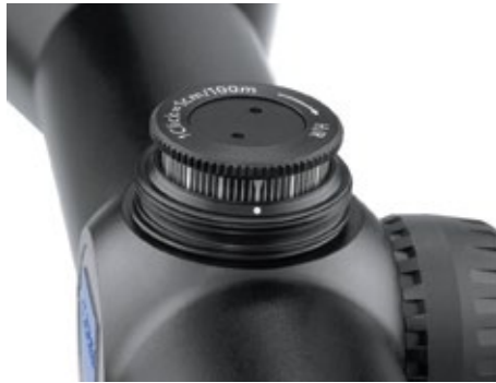
Die bedienungsfreundliche ZEISS Absehenverstellung. Nach dem Einschießen kann der Drehring amgehoben und zurück in die Nullposition gebracht werden (Nullen).
