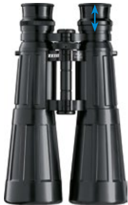
Das 8x56 GA T* Dialyt mit Außenfokussierung. Beim Scharfstellen bewegen sich die Okulare vor und zurück, das Volumen ändert sich.
