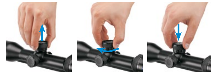
Die ASV wird durch Anheben, Drehen und Absenken des Rastrings eingestellt. Durch das sichere Einrasten des Rings ist die ASV vor unbeabsichtigtem Verstellen geschützt.
