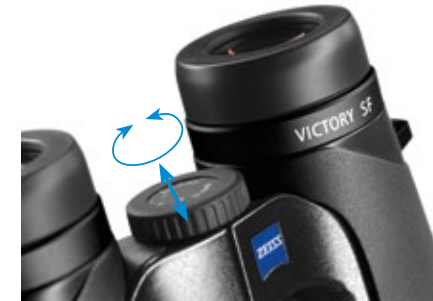
Bei den ZEISS Victory SF Modellen wird das Einstellrad herausgezogen und der notwendige Dioptrienausgleich eingestellt. Nach dem Zurücksetzen des Rades ist ein unbeabsichtigtes Verstellen ausgeschlossen.
